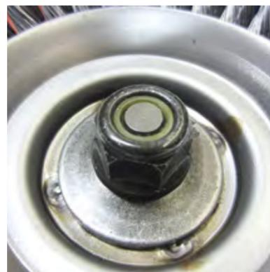
Richtiges Spannen der Bürste in die Motorsense
